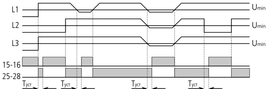
При однофазном снижении напряжения  $U_{min}$  для ЕЛ-11Е составляет  $0.6U_{ф}$ ; для ЕЛ-12Е –  $0.7U_{ф}$ ; для ЕЛ-13Е –  $0.75U_{ф}$
