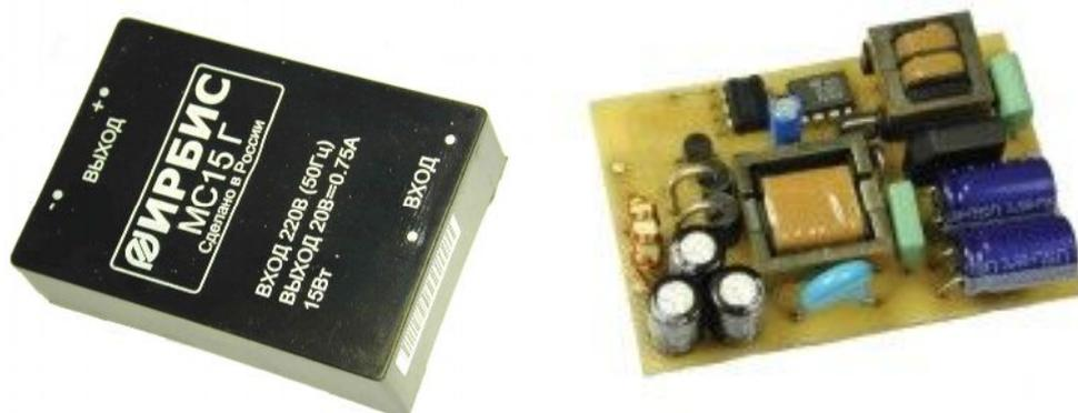
Модули питания серий MC15 и MC15–40С изготовлены с использованием технологии комбинированного монтажа на импортной элементной базе.
