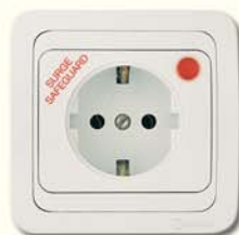
12139 Розетка с заземлением и фильтром с защитой от детей Напряжение 250V Сила тока 16A Степень защиты IP20 Максимальная поглощаемая энергия 170 Дж
