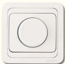
12093 Диммер Макс. мощность 1000W Мин. мощность 60W Сила тока 5A Степень защиты IP20
