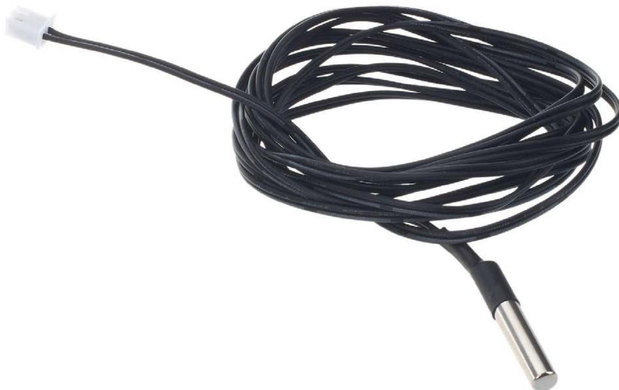
Датчик для измерения температуры в диапазоне  $-25...+125^{\circ}\text{C}$  с точностью 1%. Идеально подходит для измерения жидкостей, температуры воздуха, холодильников, морозильников, водонагревателей, инкубаторов и т.д. Сопротивление датчика 1/5/10/50кОм 1% при  $25^{\circ}\text{C}$ , при увеличении температуры сопротивление уменьшается, а при падение температуры сопротивление увеличивается.
