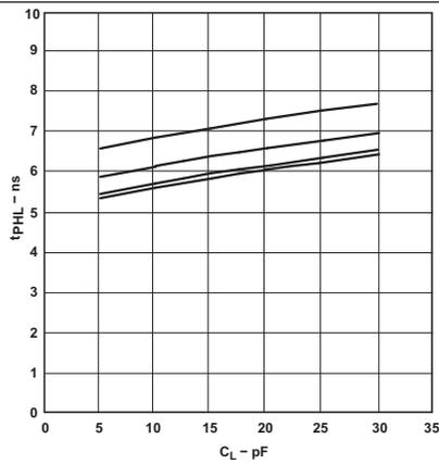
$T_A = 25^\circ\text{C}$ ,  $V_{CCA} = 2.5\text{ V}$
