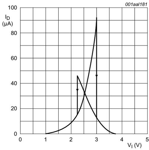
a.  $V_{DD} = 5\text{ V}$ ;  $T_{amb} = 25\text{ }^\circ\text{C}$
