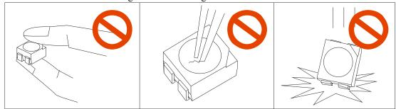
LED 的环氧树脂封装部分相当脆弱,请勿用坚硬、尖锐的物体刮、擦封装树脂部分。在用镊子夹取的时候也应当小心注意。
