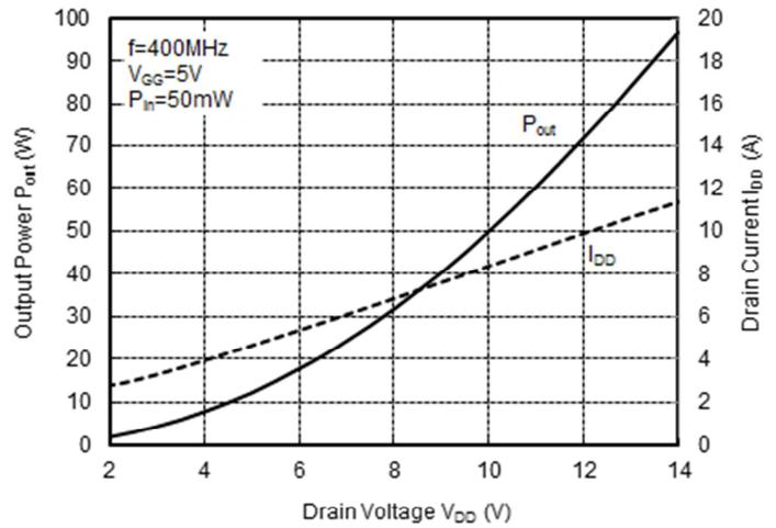
OUTPUT POWER versus DRAIN VOLTAGE
