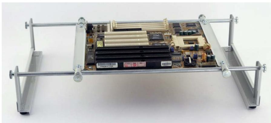
Держатель печатных плат предназначен для удержания плат над рабочей поверхностью термостола.
