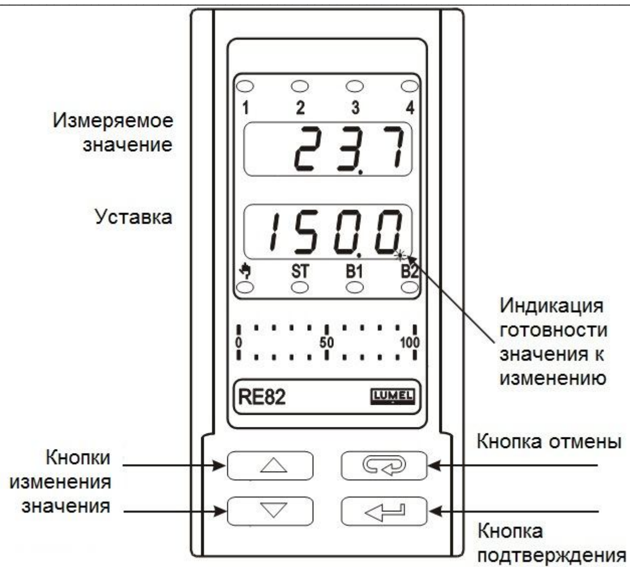
Рис.12. Изменение уставки посредством клавиатуры
