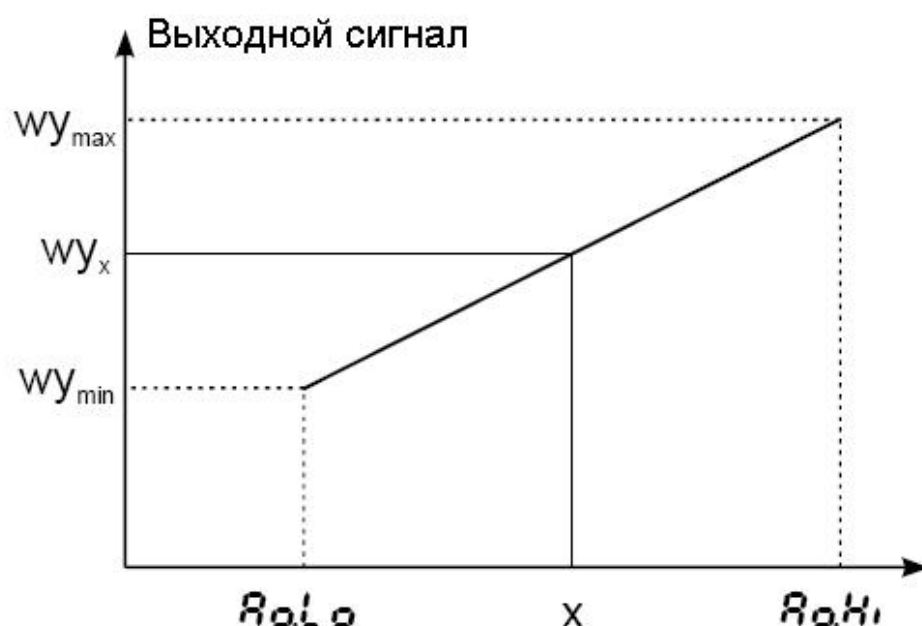
Рис.24. Пересчет сигнала в режиме повторителя
