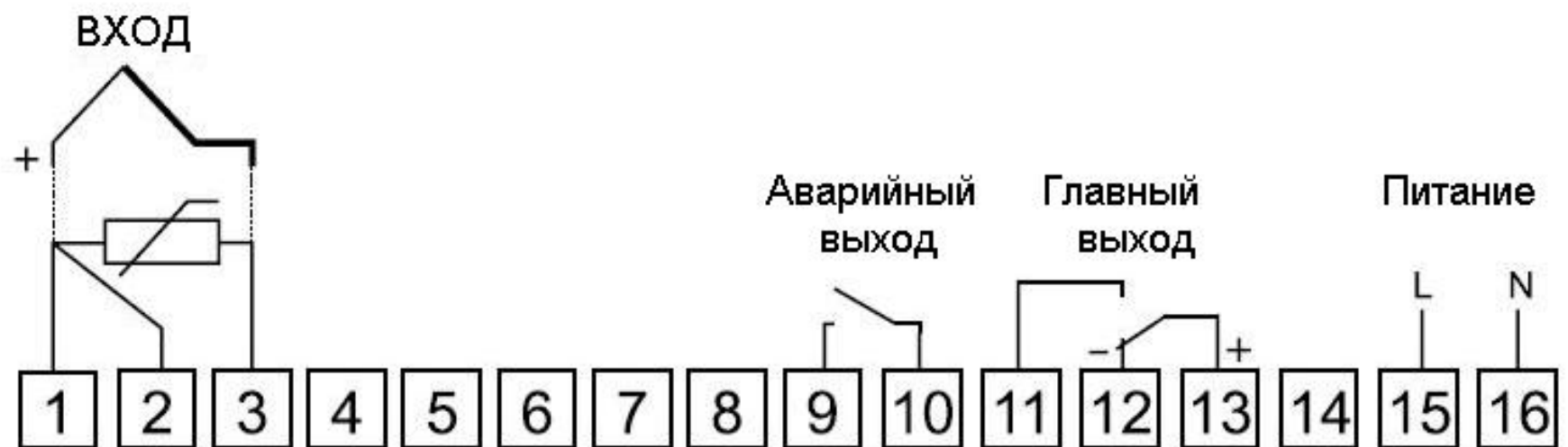
Рис.3. Описание зажимов клеммного ряда регулятора RE55
