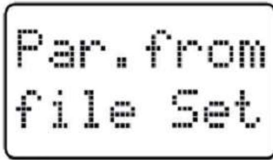
Рис.25. Сообщение подтверждающее успешное считывание конфигурации преобразователя из файла.
