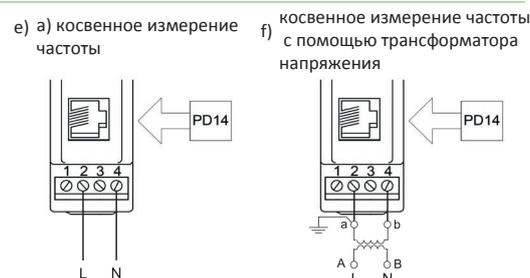
Рис. 2. Электрическое подключение входов P21Z
