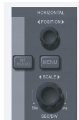
Рисунок 1-10 Зона управления горизонтальной разверткой на передней панели
