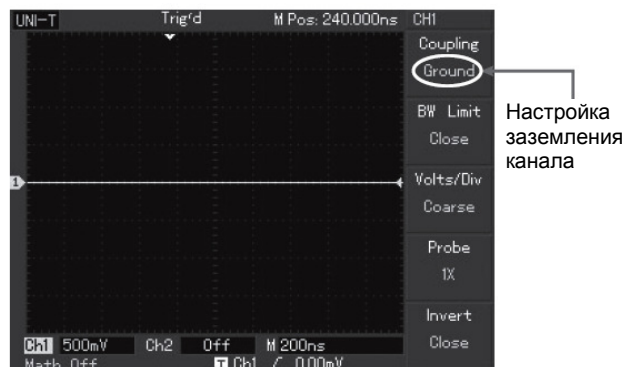
Рисунок 2-3 Отсекаются и переменная, и постоянная составляющие сигнала. (Примечание: в этом режиме сигнал остается подключенным к цепи входного канала, хотя и не отображается на дисплее)
