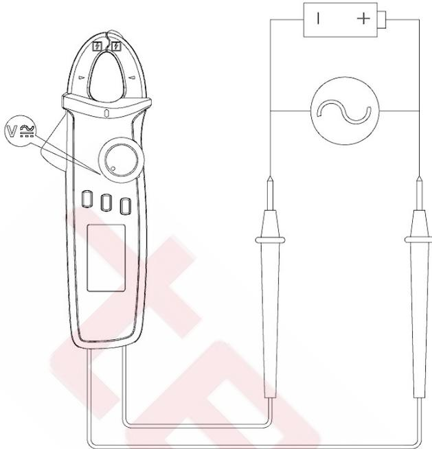
**8.2. Измерение сопротивления, прозвонка цепи, проверка диодов, измерение ёмкости и частоты**
