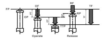
操作力 回复力 全行程力 自由位置 动作位置 OF: Operating Force RF: Release Force TF: Total travel Force FP: Free Position Operating Position OP: TTP: Total Travel Position 全行程位置 RP: Release Position 释放位置 PT: Pre Travel 行程 OT: 超行程 Over travel DT: Differential Travel 差动行程
