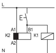
• Возможность управления внешней нагрузкой, например катушкой другого реле или таймера, соединенной с сигнальной клеммой START (B1).
