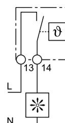
**Включение обогрева** - при снижении температуры внутри электрощита ниже заданной уставки, управляющий контакт замыкается. При достижении заданной температуры, управляющий контакт размыкается.
