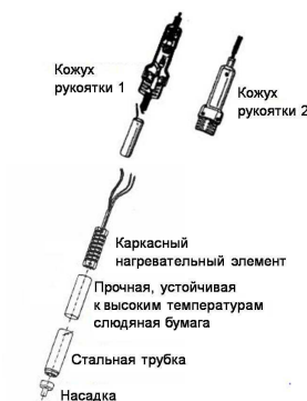
Схема разборки ручки термофена (модели с турбинным насосом)
