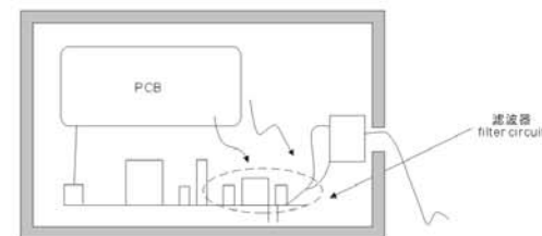
图1. 滤波器接地电阻引起的性能下降
