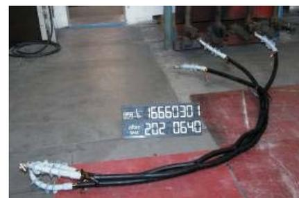
Результат воздействия динамических сил при КЗ сечение 150 мм<sup>2</sup>, I<sub>кз</sub> = 117кА расстояние между намотками 30см, кол-во слоев - 10
