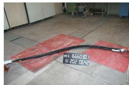
Успешные испытания при КЗ сечение 150 мм<sup>2</sup>, I<sub>кз</sub> = 127кА расстояние между намотками 20 см, кол-во слоев - 10
