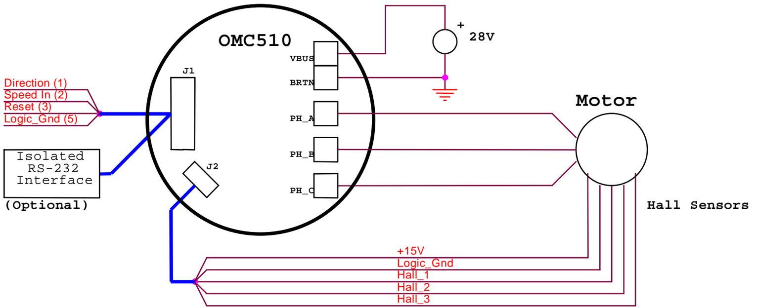
**FIGURE 1 --INTERCONNECTION DIAGRAM**
