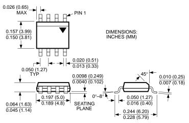
8-Lead SOIC (MM)
