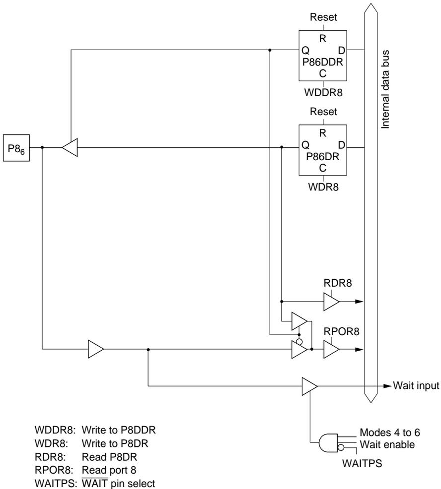
**Figure 5.34 (d) Port 8 Block Diagram (Pin P8<sub>6</sub>)**
