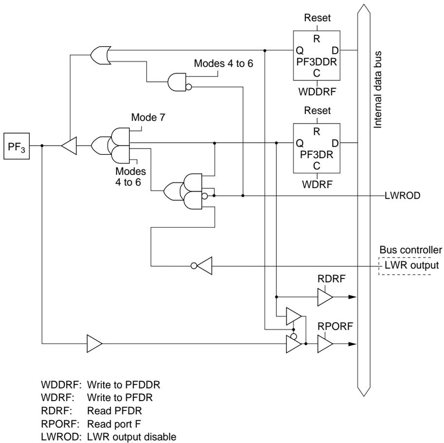
**Figure 5.41 (d) Port F Block Diagram (Pin PF<sub>3</sub>)**
