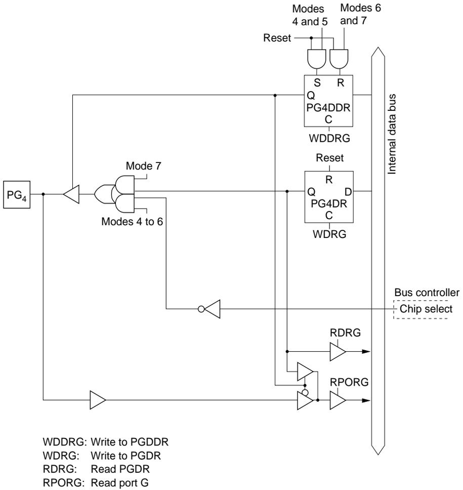
**Figure 5.42 (d) Port G Block Diagram (Pin PG<sub>4</sub>)**
