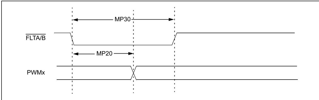
**FIGURE 22-13: MOTOR CONTROL PWM MODULE TIMING CHARACTERISTICS**
