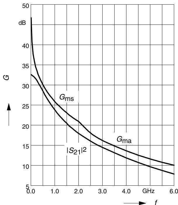
**Power gain**  $G_{\text{ma}}, G_{\text{ms}} = f(I_{\text{C}})$
