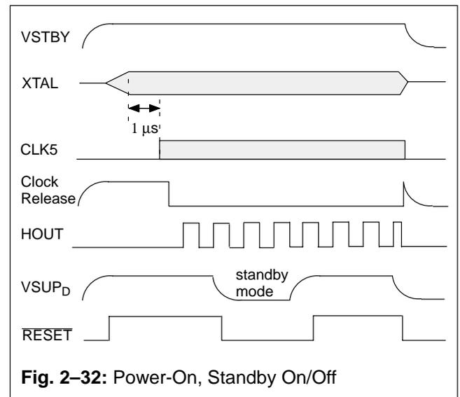
**Fig. 2–32: Power-On, Standby On/Off**
