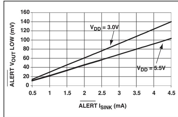
**FIGURE 2-4:**  $\overline{ALERT} V_{LOW}$  vs.  $\overline{ALERT} I_{SINK}$ .
