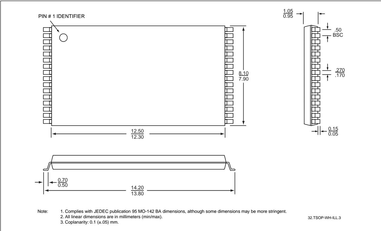
**32-PIN THIN SMALL OUTLINE PACKAGE (TSOP) 8MM X 14MM**
