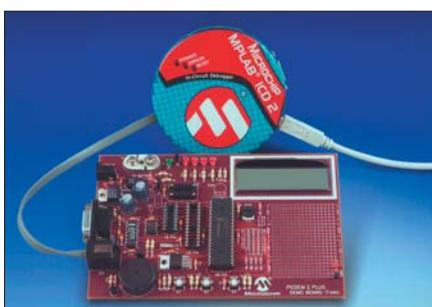
Демонстрационная плата PICDEM 2 Plus имеет ICD-разъем, ЖКИ-индикатор, звуковой излучатель и температурный датчик. Усовершенствованная PICDEM 2 Plus демо-плата
