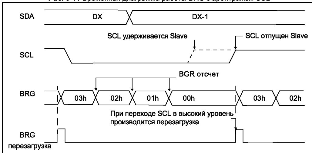
Рис. 9-11 Временная диаграмма работы BRG с арбитражем SCL
