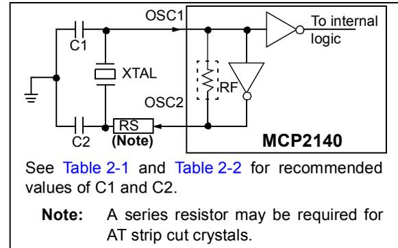
**TABLE 2-1: CAPACITOR SELECTION FOR CERAMIC RESONATORS**
