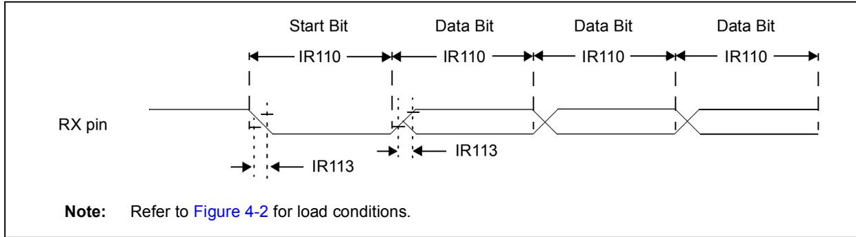
**TABLE 4-7: UART ASYNCHRONOUS RECEIVE REQUIREMENTS**
