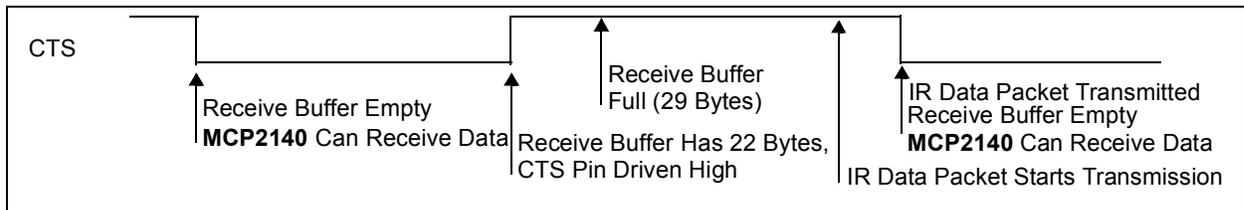
FIGURE 2-10: HOST CONTROLLER TRANSMISSION OF A 240 BYTE PACKET
