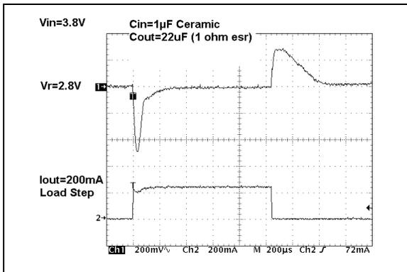
**FIGURE 2-21:** Dynamic Load Step ( $V_R = 2.8V$ ).
