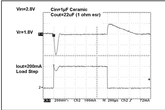
**FIGURE 2-20:** Dynamic Load Step ( $V_R = 1.8V$ ).
