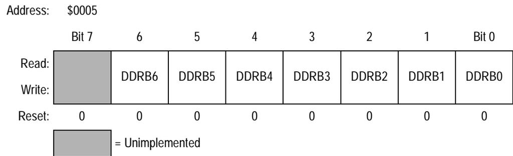
**Figure 14-6. Data Direction Register B (DDRB)**
