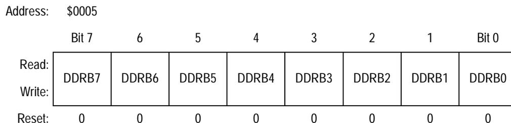
**Figure 15-6. Data Direction Register B (DDRB)**
