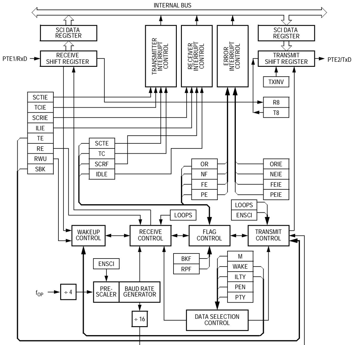
**Figure 14-1. SCI Module Block Diagram**
