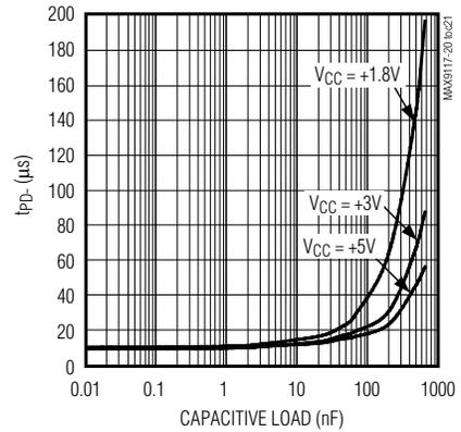
**MAX9117/MAX9119 PROPAGATION DELAY ( $t_{PD+}$ ) vs. CAPACITIVE LOAD**
