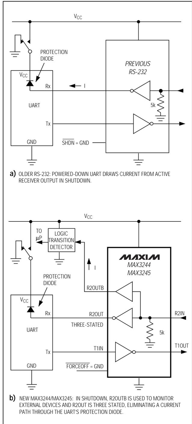
a) OLDER RS-232: POWERED-DOWN UART DRAWS CURRENT FROM ACTIVE RECEIVER OUTPUT IN SHUTDOWN.
