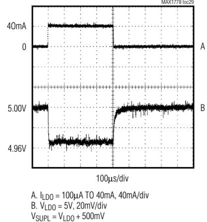
**LOAD-TRANSIENT RESPONSE NEAR DROUPOUT (INTERNAL LINEAR REGULATOR)**
