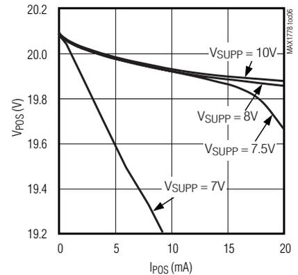
**POSITIVE CHARGE-PUMP EFFICIENCY vs. LOAD CURRENT**
