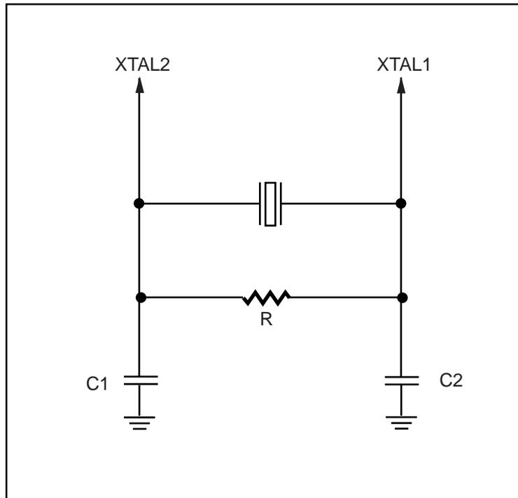
Figure 23. For High Speed (> 24 MHz)
