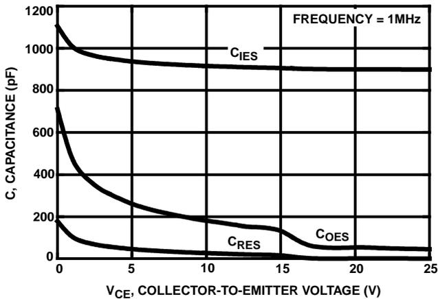
FIGURE 15. CAPACITANCE AS A FUNCTION OF COLLECTOR-EMITTER VOLTAGE
