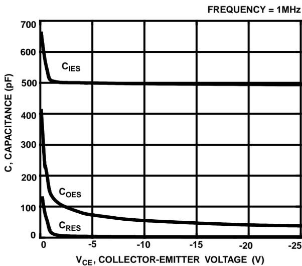
FIGURE 5. CAPACITANCE AS A FUNCTION OF COLLECTOR-EMITTER VOLTAGE
