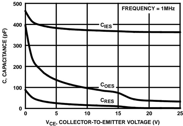
FIGURE 15. CAPACITANCE AS A FUNCTION OF COLLECTOR-EMITTER VOLTAGE
