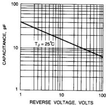
Fig. 4 - TYPICAL JUNCTION CAPACITANCE vs. REVERSE VOLTAGE
