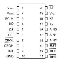
20-Pin TSSOP (4.4mm) 20-Pin SOIC (300 mil)
