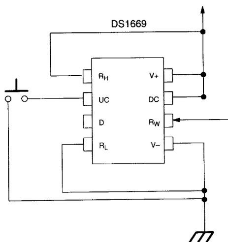
**DS1669 DUAL PUSHBUTTON CONFIGURATION (TYPICAL APPLICATION)**
