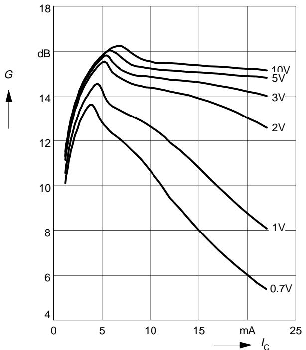
**Power Gain**  $G_{ma}$ ,  $G_{ms} = f(V_{CE})$ : \_\_\_\_\_
