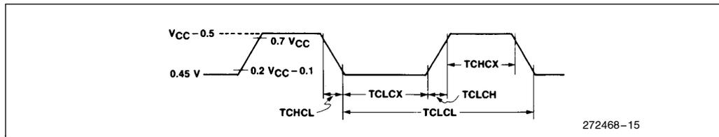
**AC TESTING INPUT, OUTPUT WAVEFORMS**
