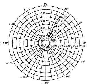
$S_{22e}$   $V_{CE}=6V$   $I_{C}=7mA$   $T_{a}=25^{\circ}C$
