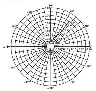
$S22e \\ VCE = 6V \\ IC = 3mA \\ Ta = 25^{\circ}C \\ (UNIT : \Omega)$
