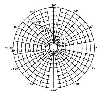
$S_{12e}$   $V_{CE}=5V$   $I_{C}=10$ mA  $T_{a}=25$ °C
