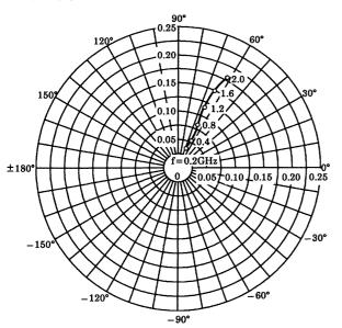
S22e VCE=5V IC=10mA Ta=25°C (UNIT:  $\Omega$ )
