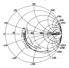
$V_{CE}\!=\!5V$   $f\!=\!200$  to  $2000MHz\,(200MHz\,Step)$
